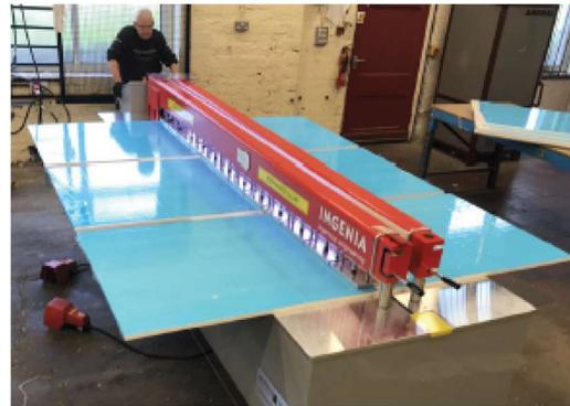
Esta máquina para **soldadura a tope** permite trabajar con placas sólidas de materiales **termoplásticos** de hasta 20 mm de espesor, sin embargo viene adaptada con un plato calefactor de 80 mm de ancho para poder trabajar con placas huecas de 50 mm de espesor (máximo de las placas Paneltim). Además de poder soldar un largo de placas de hasta 20 m lo que permite elaborar paneles de hasta 2 metros de altura en la longitud que sea necesaria para el proyecto de construcción que se vaya a elaborar.
